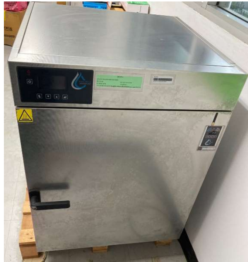
ภาพที่ 1 แสดงตู้อบลมร้อน (Hot air oven) ยี่ห้อ Pol-eko รุ่น SLW 115 STD
