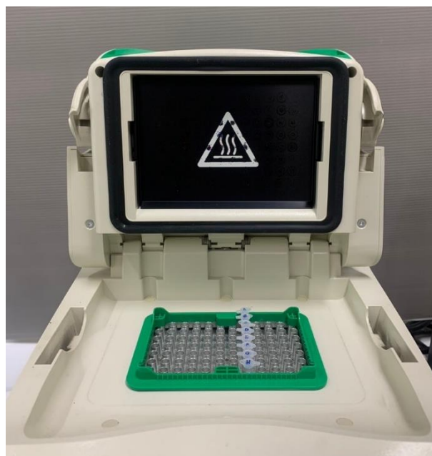
ภาพที่ 32 แสดงบริเวณฝาเครื่องที่เป็นบริเวณที่มีความร้อนสูงต้องระวังเมื่อนำหลอด PCR ออกจากเครื่อง
